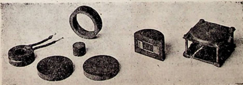
Bandfilterspoel voor draaggolftelefonie. Links de verschillende onderdeelen.
